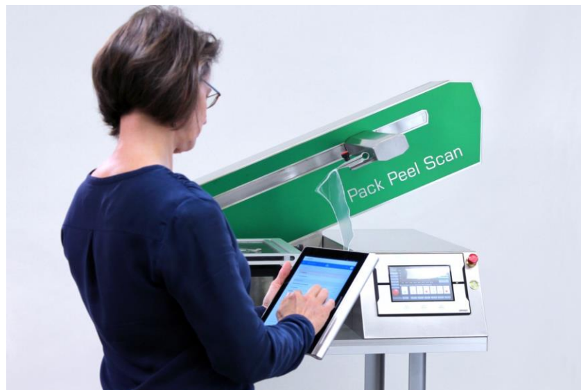
Pack Peel Scan misst Öffnungskräfte von peelbaren Verpackungen und unterstützt Maschinenbediener mit einem integrierten Assistenzsystem. (Foto: © Fraunhofer IVV)
