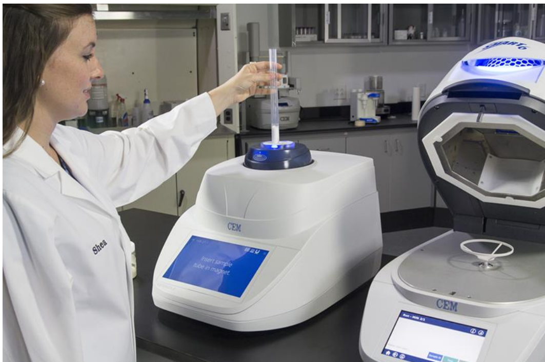
Abb. 2: Überführen der getrockneten Probe ins NMR Kernresonanzspektrometer (Trac-Modul)
