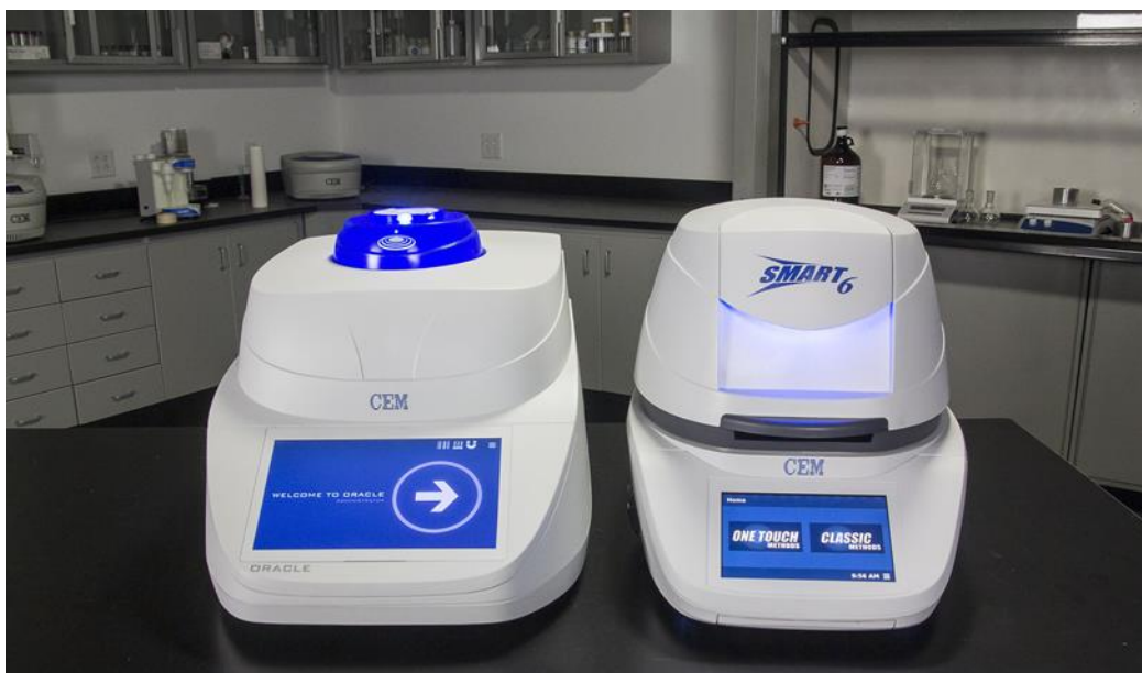
Abb. 1: Fettanalysator ORACLE als Mikrowellen- und NMR-Verbundgerät
