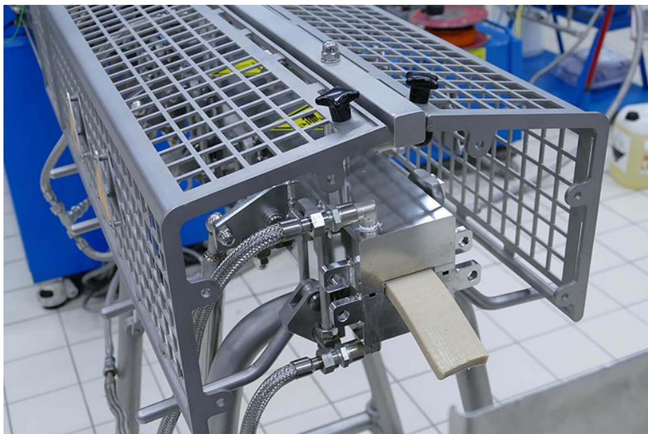
Austritt von High Moisture Meat Analogue (HMMA) aus der Kühldüse, die direkt an den ZSK Food-Extruder angeflanscht wird. (Foto: Coperion, Stuttgart)
