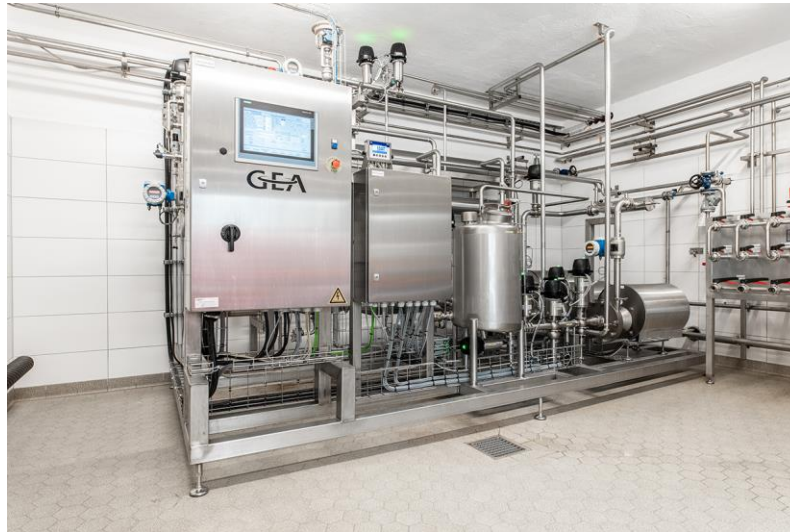
AromaPlus nutzt Umkehrosmose-Membranfiltration zur Entfernung des Alkohols bis auf 0,05 Volumenprozent. (Foto: Mike Henning)
